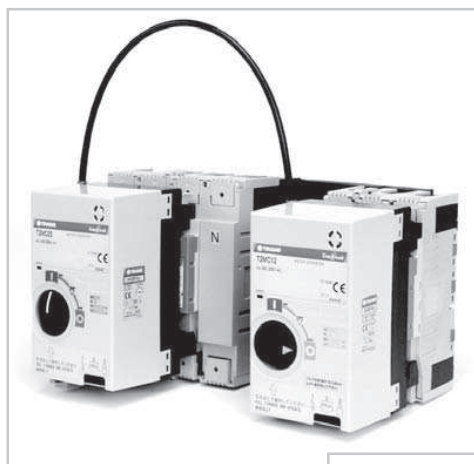
Автоматические выключатели с гибкой взаимоблокировкой и мотор-редукторами
